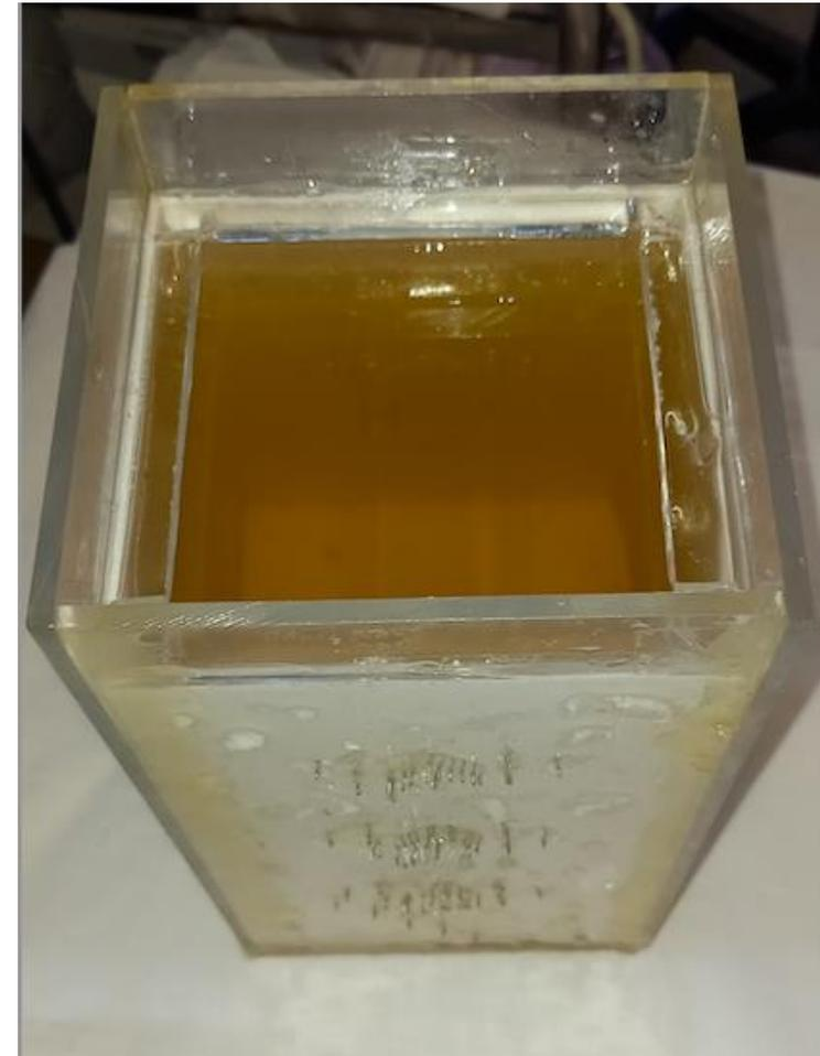
Cuve de 12\*12\*20 cm en plexiglass remplie d'huile de ricin et contenant des réseaux de fils de nylon
